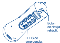
LEDS de emergencia.
